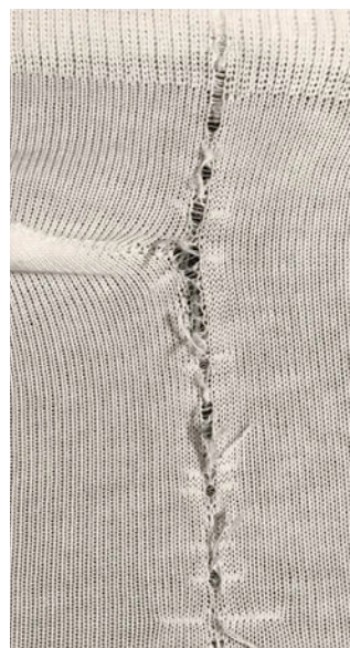
针钩断裂引起的织疵
